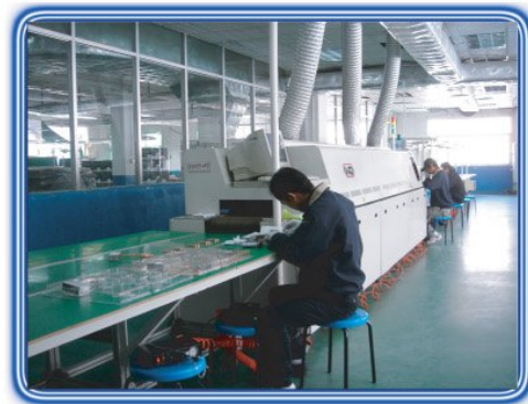
Reflow Oven 回焊爐車間
